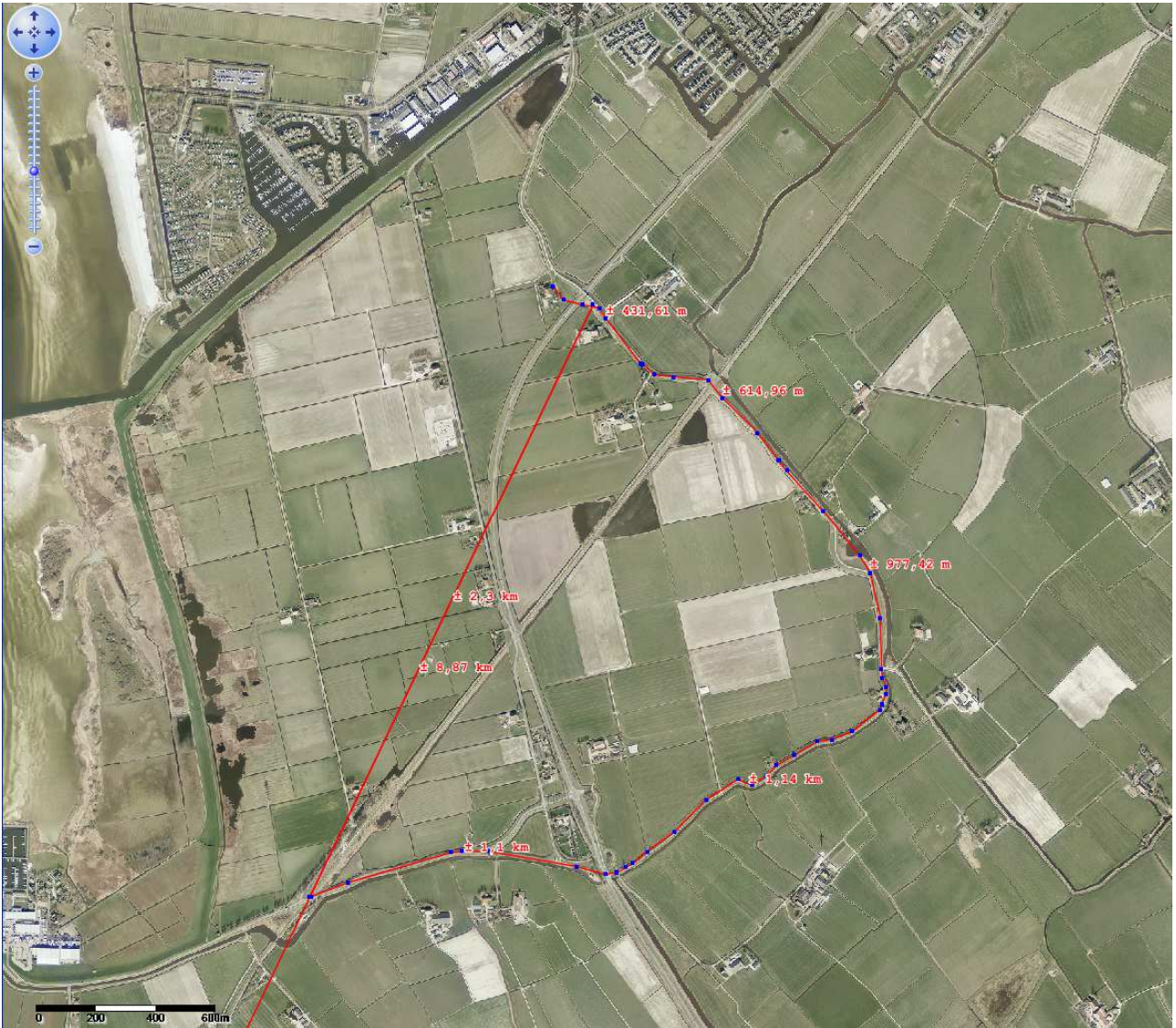
Afb. 3.14 Op bovenstaande luchtfoto is het ontwerp ingetekend zoals men dat in 1599 bedacht had. Hierbij is de Colderadam als uitgangspunt genomen en is gemeten met de Zijpse roede die 3,82 meter is. In het rood staan de afmetingen weergegeven zoals die ook in het rapport uit 1599 voorkomen.
