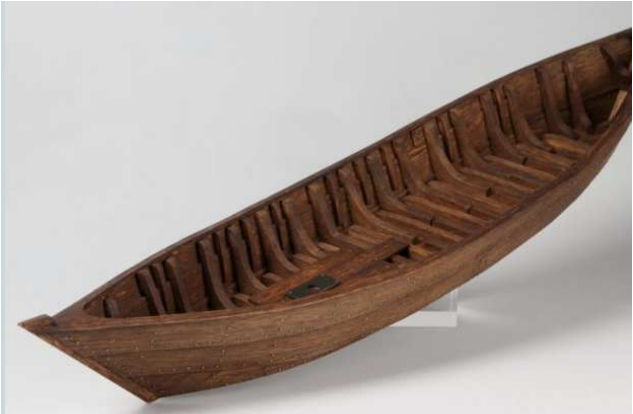
Afb. 3.15 Model van een 16 de eeuwse werkscheepje. Dit model is vervaardigd naar aanleiding van een vondst van een wrak, zoals dat werd gevonden bij opgravingen in het Workumer Nieuwland. Mogelijk is het scheepje afgezonken als golfbreker voor de daarachter aangelegde polder.
