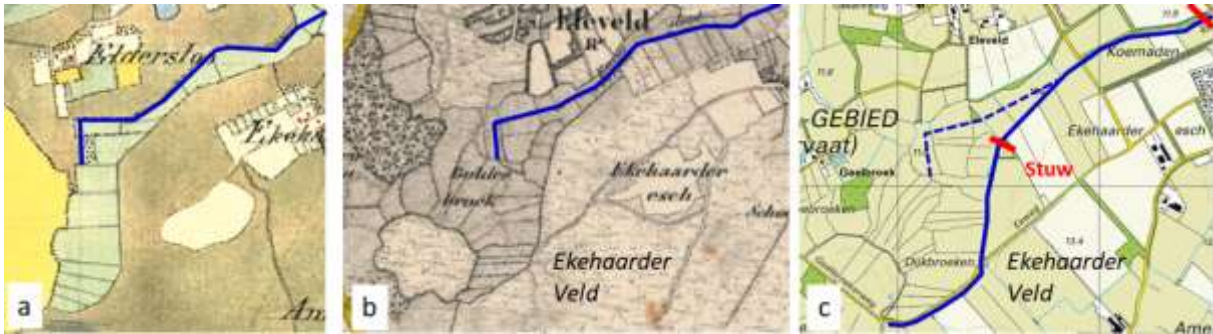
Figuur 3.29 Veranderingen in de 2 e Ruimsloot bij Ekehaar tussen 1800 en 2018: a= Huegenin kaart 1829, b = TMK 1853, c = topografische kaart 2018. De bovenloop van de ruimsloot is omgelegd, verbreed en verdiept ten behoeve van het ontgonnen en heringerichte Ekehaarder Veld.
