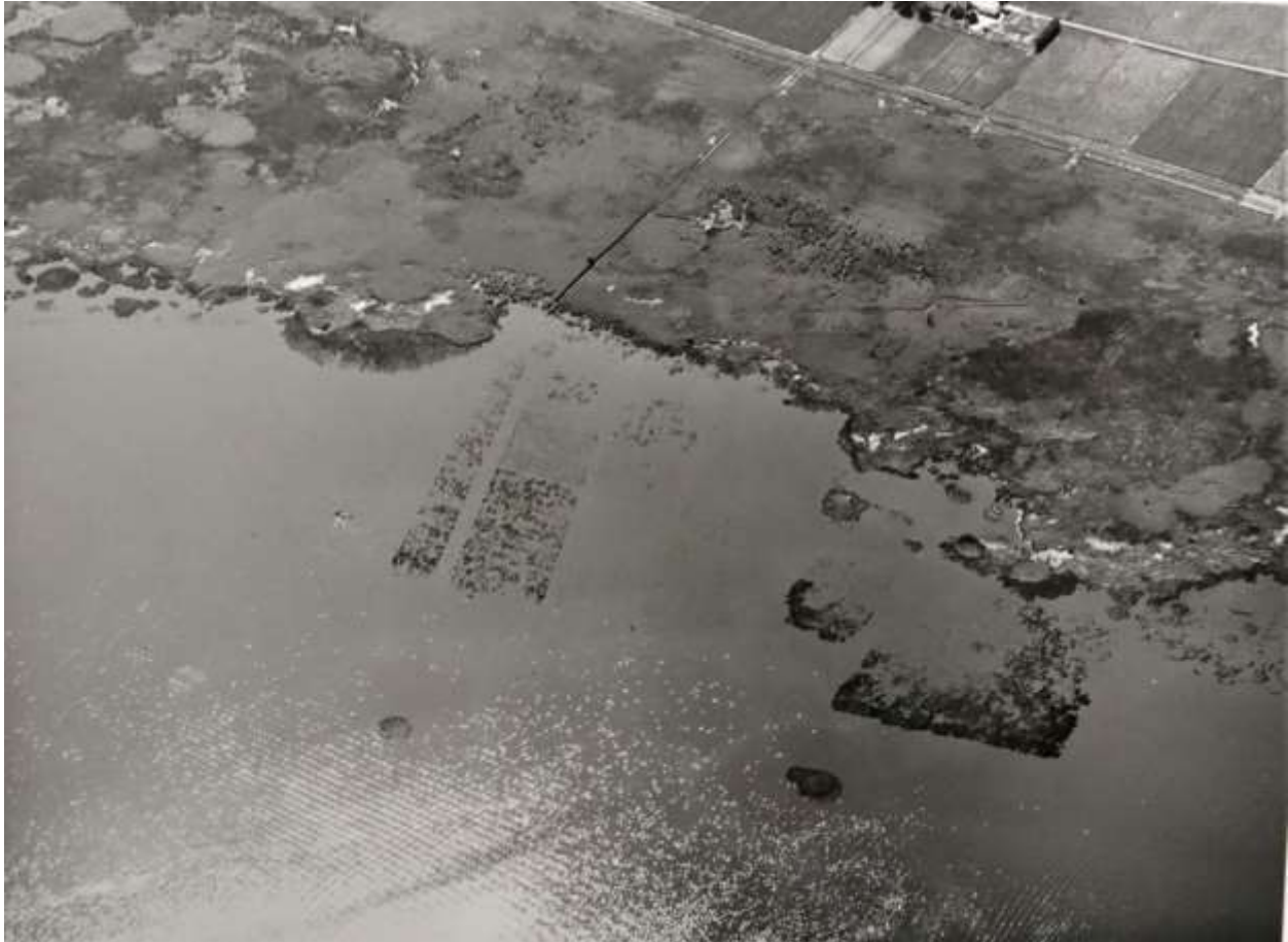
Figuur 4.11: Het actief aanwassen van land. Deze luchtfoto uit 1985 toont het aanwassen van land aan de noordzijde van de Willem Meyerspolder. De stad Kampen doet dit door middel van het plaatsen van rijshout in het water. Daartussen slibt land op.
