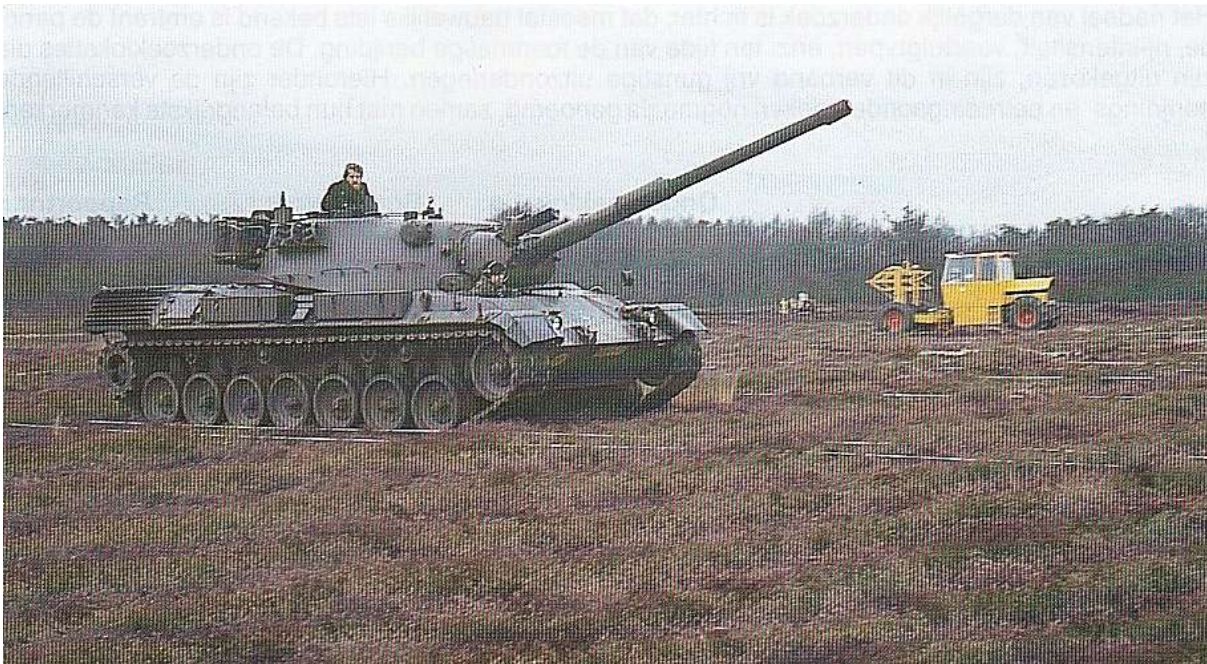
Afbeelding 1.8 Proefopstelling voor de berijdingsproeven in de heide op een militair oefenterrein, hierbij zijn wieltesters, zoals op de achtergrond en militaire rupsvoertuigen gebruikt. Samenvattend onderzoek rapport 16, Beije, 1986, RIN.
