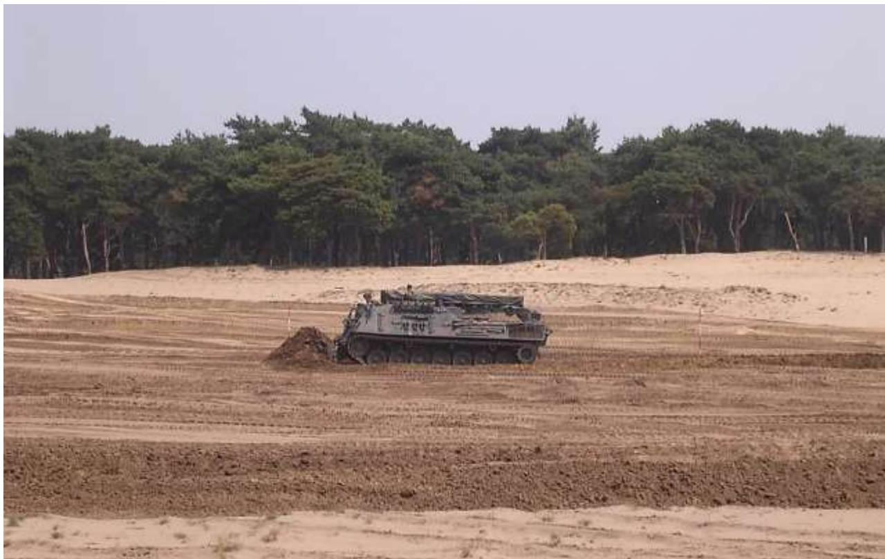
Afbeelding 1.1 Het oefenen in het maken van een tank- of antitankgracht, een diepe en brede gracht die voor tanks en pantservoertuigen onmogelijk is om over te steken, door een Leopard 1-genietank. In het zogenaamde Vrij Terrein gebied van het militaire oefenterrein Weerterheide. Foto auteur, augustus 2012.
