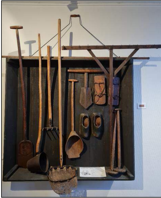
Afb. 12. Gereedschap voor het winnen van veen onder de waterspiegel, het vierde stuk gereedschap van links betreft de baggerbeugel (bron: Museum Opsterlân, eigen foto).
