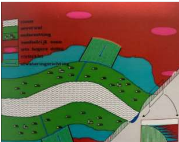
Fase 2: Eerste ontginningsfase, waarin aan beide kanten van de rivier één ontginningsblok is uitgewerkt.
